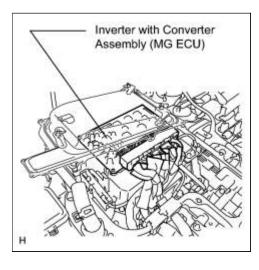
(d) Check the connections of the MG ECU connectors.
