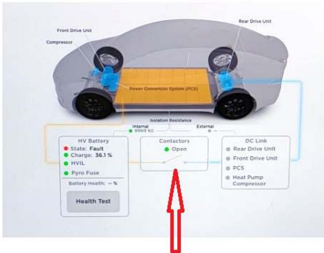
Simultáneamente los contactores se abren y a partir de ese momento el vehículo ya no puede ser conducido.
